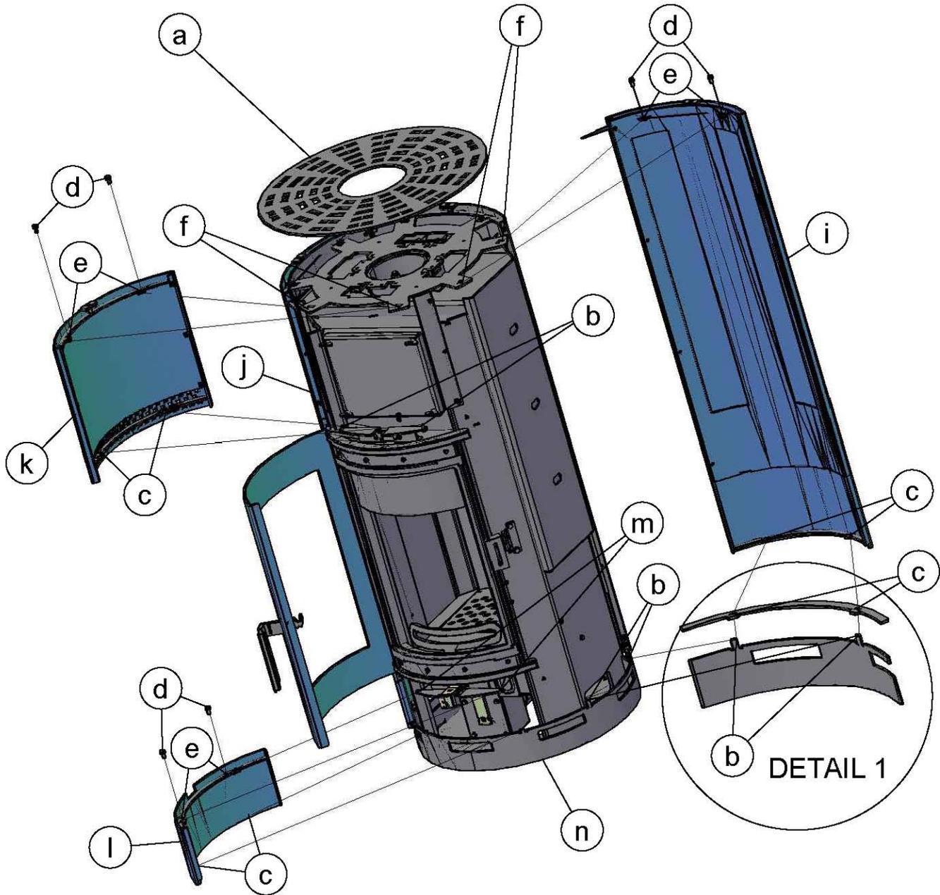
Abbildung 1- Darstellung Montage Verkleidungen
